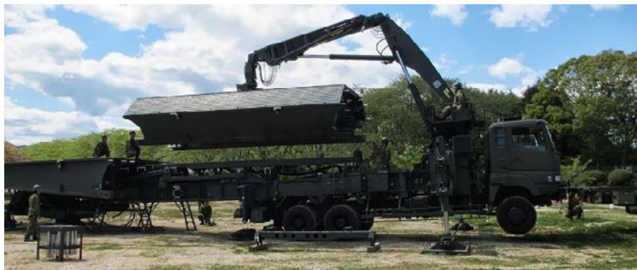
Rys. 27. Type 07 – pojazd układacz manipulujący przęsłem [31]
