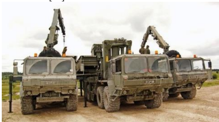
Rys. 20. BR90 GSB pojazd układający wraz z dwoma pojazdami transportowymi [26]
