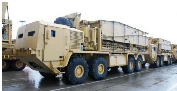
Rys. 21. BR90 GSB – pojazd transportujący z własnym żurawiem [26]
