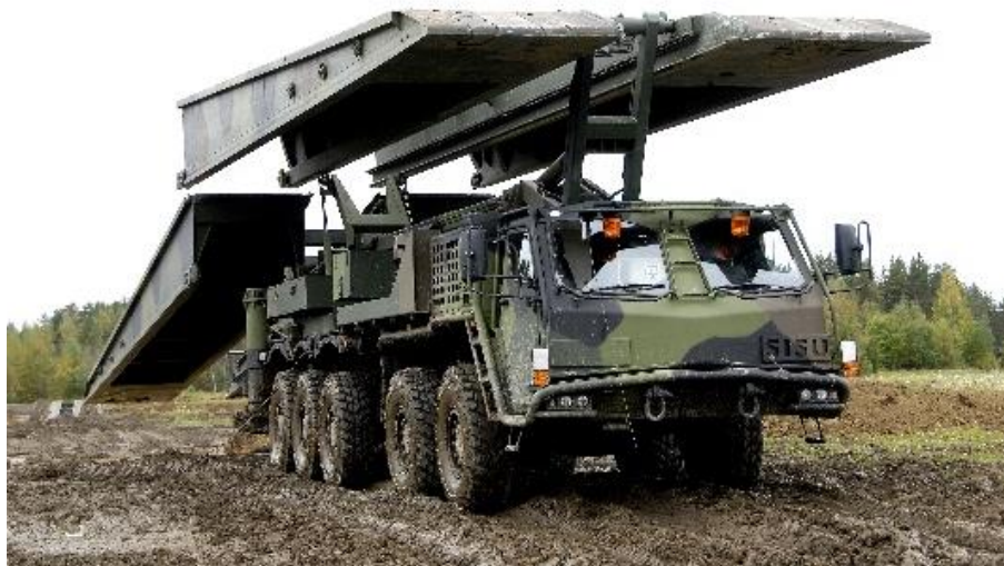
Rys. 11. Sisu E15TP z przęsłem Leguan [16]
