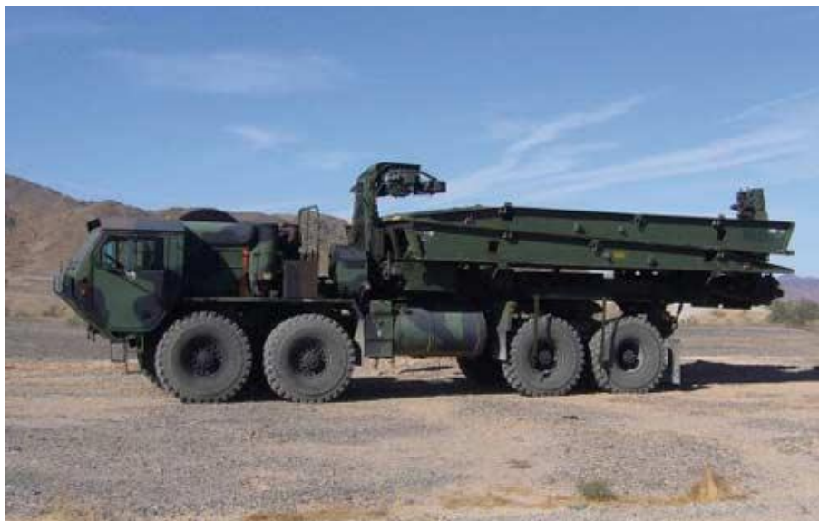
Rys. 14. Most PYTHON na podwoziu HEMMT M1977 CBT [15]
