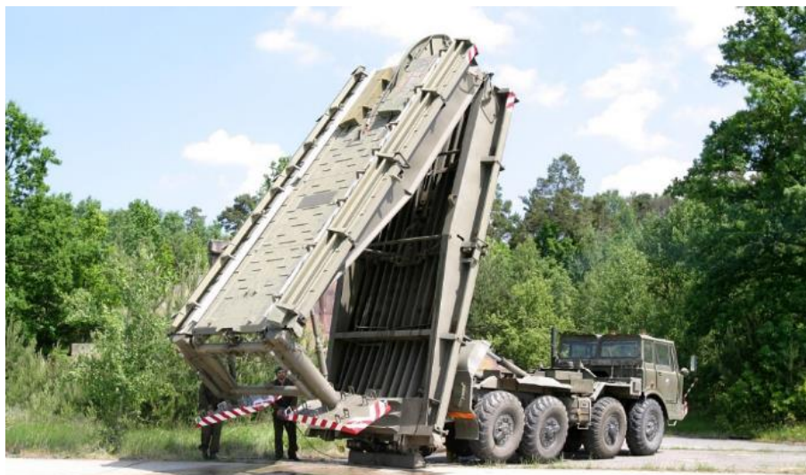
Rys. 8. Podpory hydrauliczne mostu AM-50 [13]
