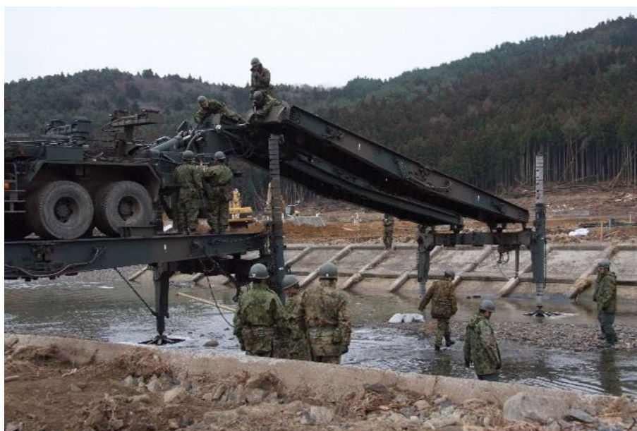
Rys. 18. Type 81 most z podporami wysuwany z pojazdu układacza [23]
