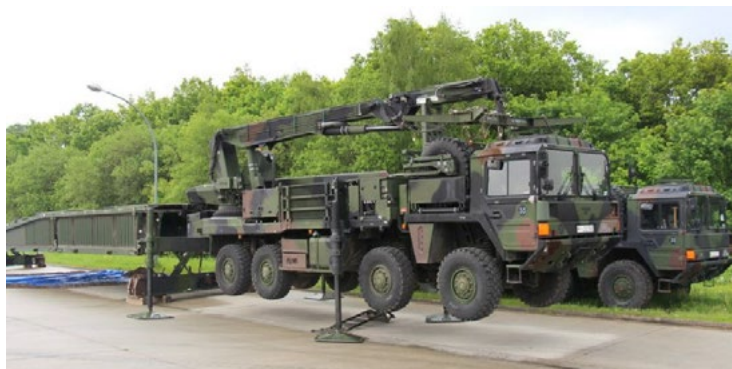
Rys. 19. Dornier Foldable Bridge – podczas wypoziomowania na podporach [25]
